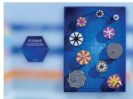
Декоративная панель, на которой в определенном порядке закреплены диски различного диаметра, соединенные между собой приводным ремнем, позволяющим передавать механическую энергию за счет трения между ремнем и шкивом. На одном из дисков установлена ручка, при ее вращении энергия вращения передается всем дискам, задействованным в ременной передаче.
