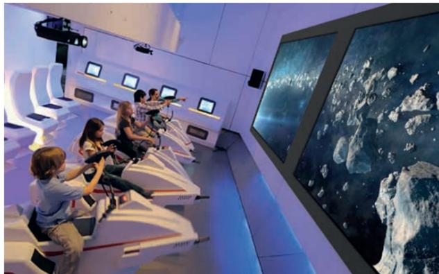
Представляет собой аппаратно-программный интерактивный комплекс с пятью игровыми местами на трехступенной динамической платформе, выполненными в виде космических истребителей с установленными имитаторами вооружения и системой визуализации в виде двух панорамных экранов. Для создания полного погружения в игровой мир на стрелковой консоли установлена вибрационная система и дополнительный комплекс светозвукового воздействия.
