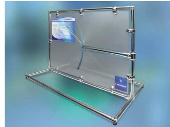
Экспонат представляет собой конструкцию высотой 700 мм, на которой расположена шарнирно закрепленная прямая, которая при вращении проходит через прорезь сложной формы (гиперболическая). Экспонат объясняет, почему вращающийся отрезок прямой проходит через прорезь сложной формы.
