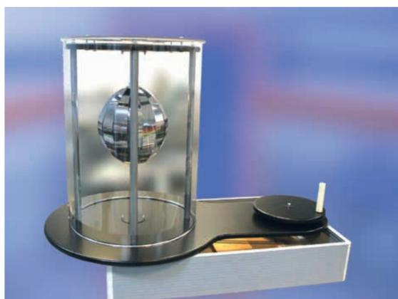
Экспонат состоит из вертикально установленного вала вращения и закрепленных на нем лепестков, собранных в элемент шарообразной формы. Позволяет наглядно продемонстрировать воздействие центробежных и центростремительных сил на вращающееся тело – и в данном случае объяснить эллипсоидную форму Земли.
