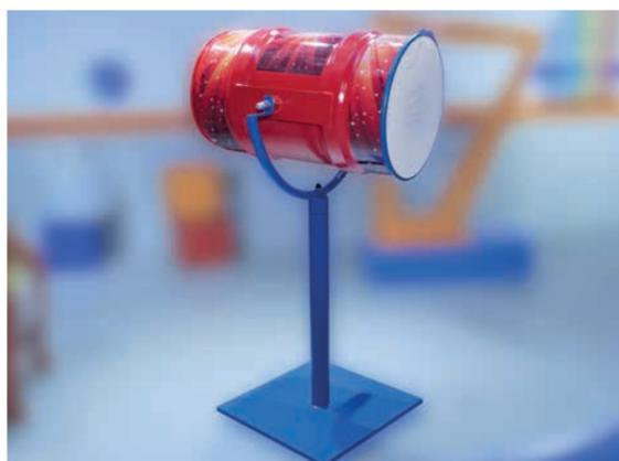
Установив метательный снаряд в выходное отверстие и оказав ударное воздействие на мембрану, можно произвести «выстрел», траектория и дальность полета метательного снаряда зависят от силы воздействия на мембрану.
