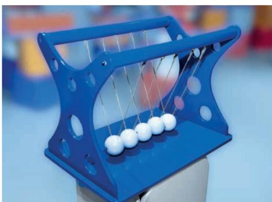
Механическая система, состоящая из 5 шариков, подвешенных к металлической рамке на гибких нитях. Придумана Исааком Ньютоном для демонстрации преобразования энергии различных видов друг в друга: кинетической в потенциальную и наоборот.
