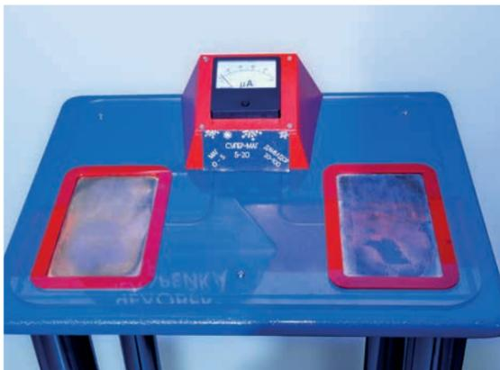
Это абсолютно ничем не питаемый электронный прибор, составляющий замкнутую электрическую цепь «медная пластина – человек – цинковая пластина – микроамперметр – медная пластина». Экспонат наглядно демонстрирует закон накопления заряда и энергии электрического тока.
