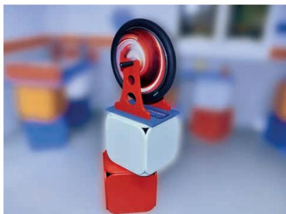
Учебный экспонат представляет собой конструкцию, состоящую из колеса диаметром 500 мм, установленного на декоративном основании. Экспонат поясняет принцип работы гироскопа, отвечая на вопрос, почему велосипедом и мотоциклом, мчащимися на большой скорости, несложно управлять.
