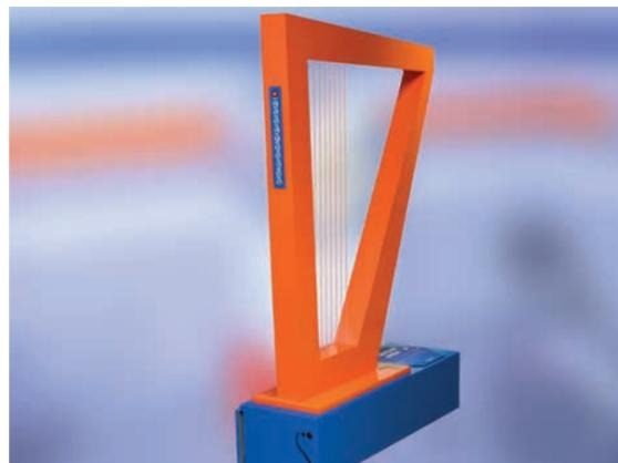
Звук синтезируется при помощи генератора звуковых волн и арфы, по периметру деки которой расположены компактные фотоэлектрические датчики с лазерными источниками света. Возможность игры на инструменте достигается за счет прерывания лазерных лучей пальцами исполнителя и передачи MIDI команды на электронный музыкальный инструмент.
