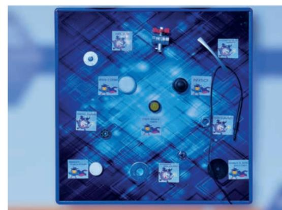
Электрифицированный стенд с стилизованным тематическим изображением и светодинамической индикацией, на лицевой поверхности которого размещены натурные образцы различных материалов и изделий. Позволяет на практике изучить разницу между проводниками и диэлектриками.
