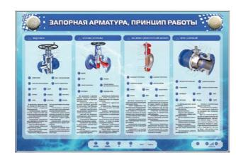
Стенд представляет собой полноцветную светодинамическую панель, на которой размещена информация о видах запорной арматуры, областях ее применения с кратким описанием устройства и основных характеристик.
