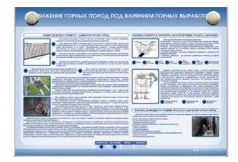
На стенде представлена информация о сдвижении горных пород под влиянием горных выработок, об общей зоне сдвижения земной поверхности, зоне опасных сдвижений, зоне плавных сдвижений, зоне трещин, зоне обрушения, зоне воронок и провалов.
