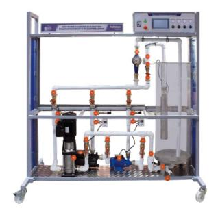
Лабораторный стенд для изучения устройства насосов для систем водоснабжения и водоотведения предназначен для изучения устройства, принципа работы и особенностей насосного оборудования, которое применяется в системах водоснабжения и водоотведения – горизонтальные поверхностные центробежные, вертикальные поверхностные центробежные многоступенчатые, скважинные погружные центробежные многоступенчатые, горизонтальные поверхностные вихревые.
