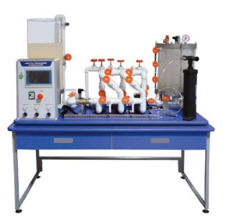
Стенд учебный для проведения лабораторных работ по изучению принципов работы насосных станций предназначен для проведения лабораторных занятий по изучению принципов работы и экспериментальному определению характеристик насосных станций при последовательном и параллельном соединении насосов, изучения принципа работы безбашенной водокачки и исследования потерь давления на трение при течении жидкости по трубопроводу.
