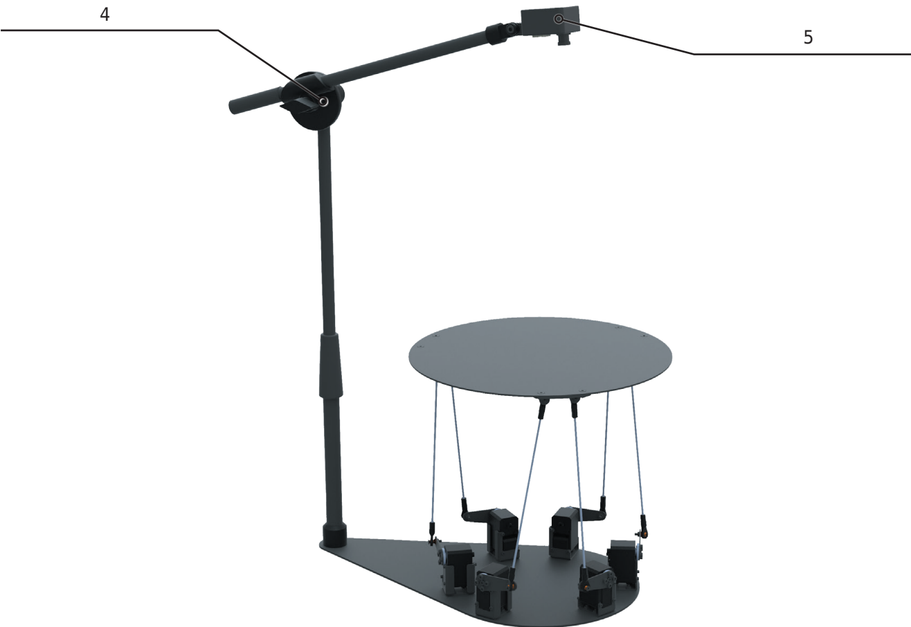
Рисунок 5. Общий вид платформы Стюарта (гексапод) в сборе: 4 – Стойка крепления модуля технического зрения; 5 – Модуль технического зрения
