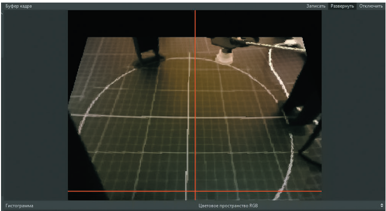
Рисунок 9. Пример расположение перекрестия относительно основания робота
