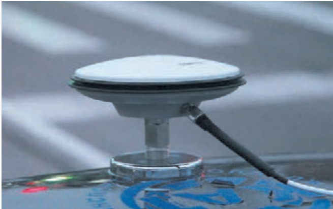
Датчик системы сверхточного позиционирования в системе глобальных спутниковых сетей GPS/ГЛОНАСС
