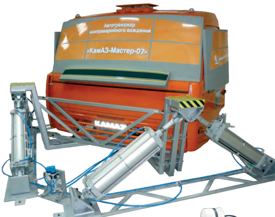
T0105 Автотренажер контраварийного вождения «КамАЗ-Мастер-07» (оригинальная кабина автомобиля КамАЗ, установленная на шестистепенную динамическую платформу)
