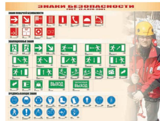
Базовый комплект состоит из двух секций, представляющих собой интерактивные информационные панели с отдельной светодиодной индикацией. На панелях изображены 126 знаков безопасности, каждый из которых может подсвечиваться индивидуальным световым сигналом. Секции соединены между собой управляющим кабелем и вместе представляют электрифицированный двухсекционный световой стенд.
