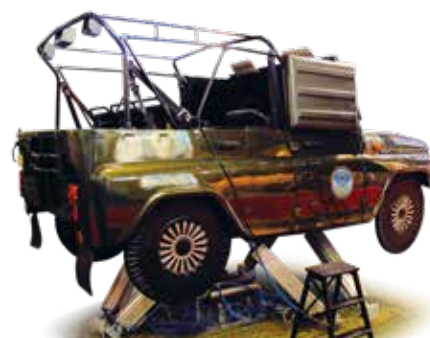
T0029 Автотренажер контраварийного вождения (оригинальный кузов автомобиля УАЗ, установленный на шестистепенную динамическую платформу)
